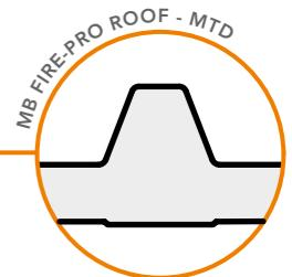
I pannelli metallici bilamiera con isolamento in lana di roccia minerale a fibre orientate Marcegaglia RWD sono ideali per la realizzazione di coperture discontinue con pendenze >7% di edifici civili o industriali che necessitano di particolari prestazioni di reazione e resistenza al fuoco.
