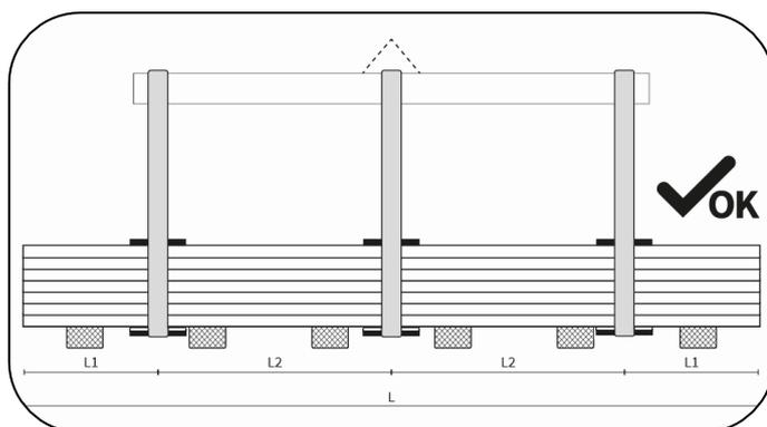
Durante la manipulación, los bultos deben estar siempre sujetos con eslingas en al menos dos puntos, distantes entre sí a no menos de la mitad de la longitud de los bultos mismos.
