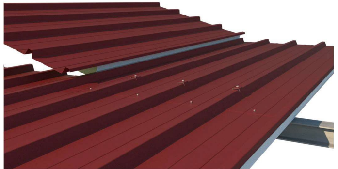
3. Die Überlappungsphase abschließen, indem die Paneele einzeln in Position gebracht werden; darauf achten, dass sie ordnungsgemäß mit den Schrauben befestigt werden.
