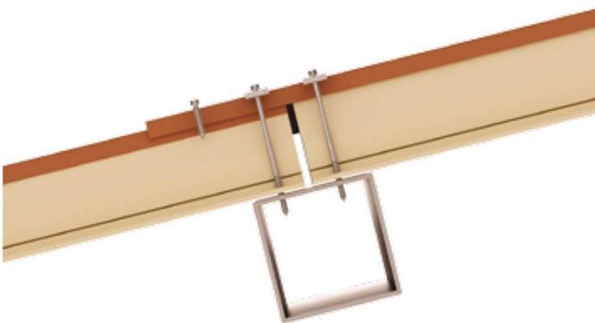
Auf diese Weise werden die Scherspannungen über die Befestigungselemente besser auf die Tragkonstruktion übertragen. Dieses Schema eignet sich besonders für sich überlappende lange Paneele.
