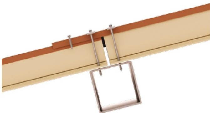
In questo modo le sollecitazioni di taglio vengono più efficacemente scaricate sulla struttura portante, tramite i gruppi di fissaggio. Tale schema è indicato soprattutto per sormonti di pannelli di lunghezza elevata.
